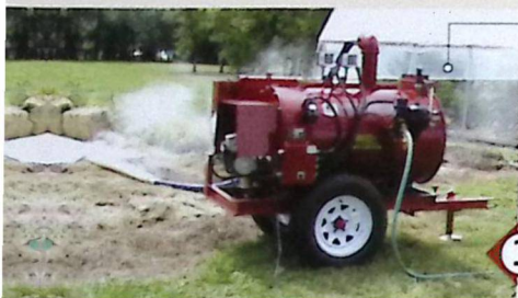
Desinfección de suelos con vapor
