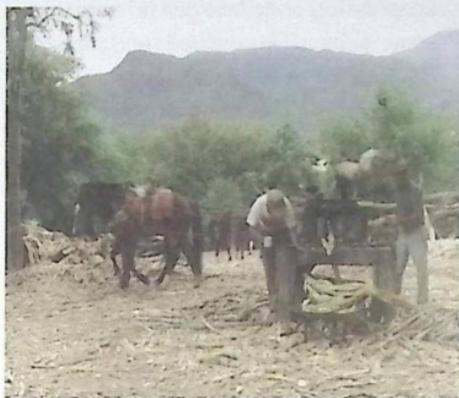
**Foto 2.3.:** Imagen que representa la realidad en el proceso de molienda de la caña de azúcar con tracción animal.
