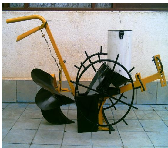
Sembradora de maní con aletas, para la formación de surcos con camellon para riego
