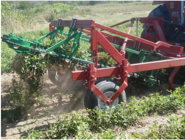
Prueba de una arrancadora invertidora de maní, fabricado por la Empresa CAREYSO Com. Zapallar - Montegudo
