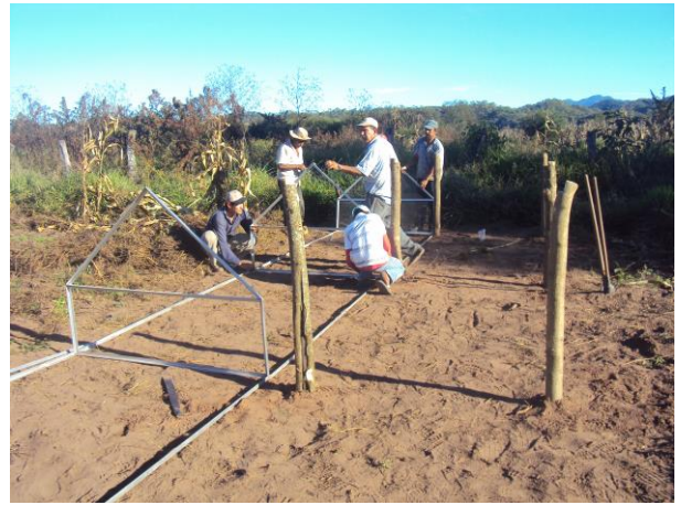
Capacitación a productores de APROMAJI-Muyupampa, en armado de un secador solar de ají Com. Ciraopampa-Muyupampa
