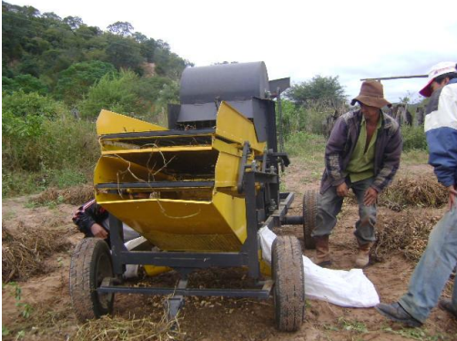
Despicao de maní con despicatora estacionaria Comunidad Cerrillos – Monteagudo Gestión agrícola 2009
