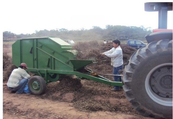
Despicao de maní con despicatora a toma fuerza del tractor agrícola Centro Experimental Iboperenda Gestión agrícola 2010
